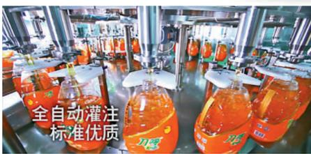
南順食用油脂工廠採用高度自動化灌注設備，精度高、速度快。
